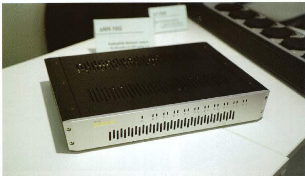
↑写真はミュンヘンで開催されたHIGH END 2018の様子。8ポートのLAN (RJ45) 端子を装備し、オプションで10MHzのクロック入力にも対応する。発売時期や価格は未定
